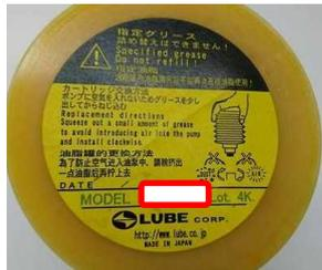
型式を確認、指定品以外を使用しますと、ポンプ、機械部品が壊れます。
